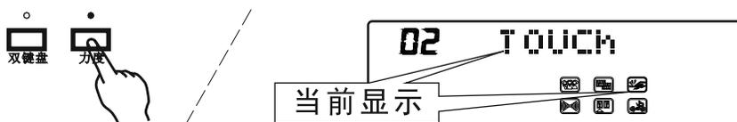
4.2 共有4种力度类型，按一下力度键，LCD显示当前力度(TOUCH)的类型，预设值为第2档（LCD暂显02）。再连续按键，则LCD显示相应改变为第3档、OFF档、第1档、第2档，以此类推。
