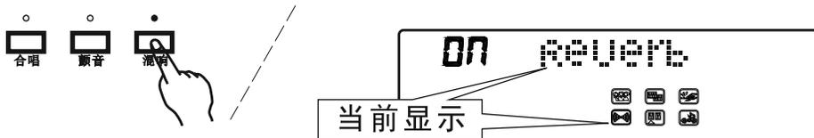
开机后，预设混响和合唱效果为打开状态，此时具有数码效果，相应的指示灯亮。若按一下混响键，则关闭混响效果，相应的指示灯熄灭。再按则打开。合唱的操作与其相同。
